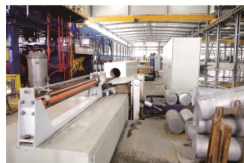
φ310mm铝棒梯度加热炉用于甘肃宏达铝业
