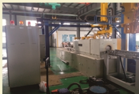
228mm镁棒变频梯度加热炉用于南京云海特种金属有限公司 228mm Magnesium Bar Frequency Conversion Induction Gradient Heating Furnace
