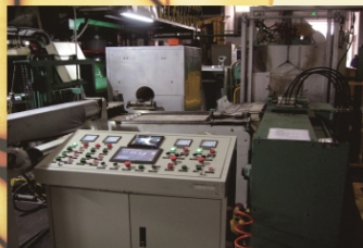
228mm铝棒变频梯度加热炉用于捷安特轻合金科技有限公司 Induction Gradient Heating Furnace after Gas Preheating
