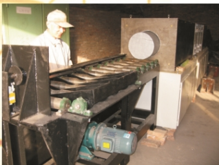
加热铝棒出炉铝棒直径350毫米 Tapping of hot aluminum bar with 350 mm diameter
