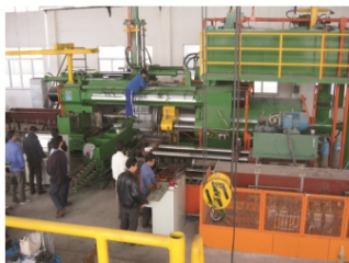
在西安航空发动机集团加热炉调试中 Induction-heated furnace in debugging
