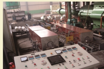
双工位变频梯度加热炉用于河北山山铝业公司 Two parallel induction gradient heating furnaces
