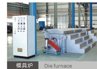
模具炉 Die furnace
